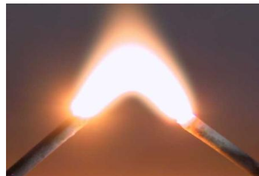
Βολταϊκό τόξο ανάμεσα σε δύο μεταλλικά καρφιά, προκαλούμενο από ρεύμα 3000 Volt
