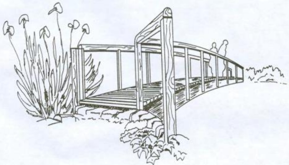
Σχ. 2.10 Σκίτσο ξύλινης γέφυρας με διπλή κουπαστή.
